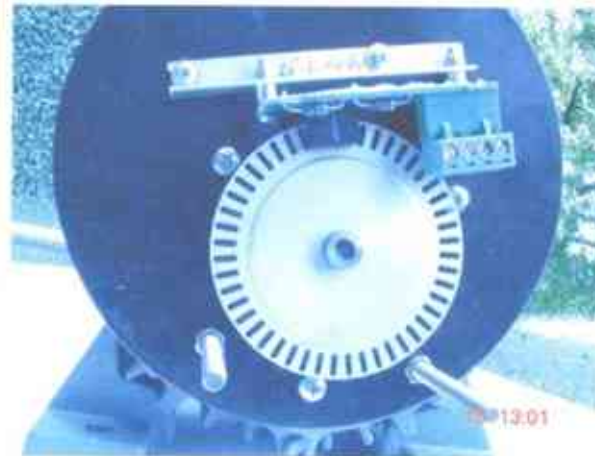
Ringemaskin CLOCKO fra 1996/1967 Teller motorens omdreiningstall og gir signal til et programmerbart elektronikk-kort.
