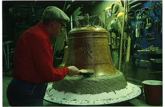
Oppbygging av ytre form. Making the cope.
