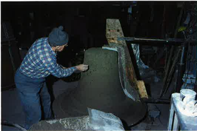
Oppbygging av kjernen. Building the core.
